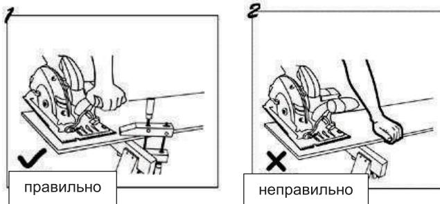
Зафиксируйте заготовку. Проследите за тем, чтобы распиливаемая заготовка была уложена лицевой стороной вниз, поскольку кромка с нижней стороны получается более аккуратной. Включайте пилу до того, как она прикоснется к заготовке. Не прилагайте чрезмерного усилия к пиле: обеспечьте плавную подачу пильного диска к обрабатываемому материалу.
