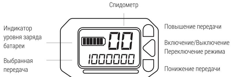
Режим: пробег в течение последнего сеанса использования, Одометр, Время в пути, Напряжение на АКБ
