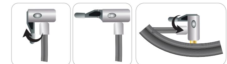
**э)** Накачайте колесо до нужного Вам давления и снимите концевик воздушного шланга с ниппеля накачиваемого устройства (выполните действие пункта В в обратном порядке)
